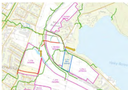
Obr. 7 Příklad vymezení přirozených svodnic pro rozvojovou plochu 1_41a Zavadilka (zeleně přirozené svodnice, červeně doporučená trasa vedení dešťových vod) (Hrabák, 2019).
