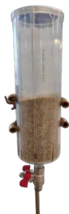
Obr. 2. Kolóna s pieskom určená na filtráciu po koagulácii.
